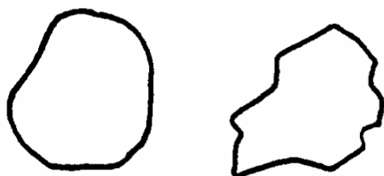
Kuva 5. Pyöristynyt rae vasemmalla ja särmikäs rae oikealla.
