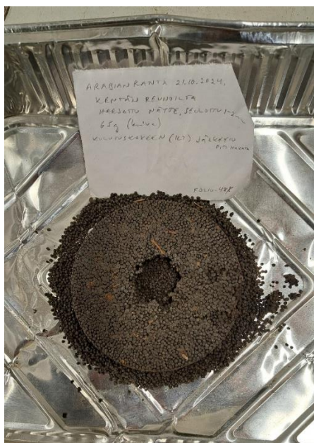
Kuva 43. Saltex BioFill -rakeet kulutuskokeen jälkeen.
