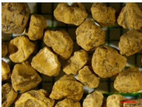
Kuva 12. Oliivinkivirouhenäyte Ikurin kentältä. Kuvassa punainen mittajana on 1 mm.
