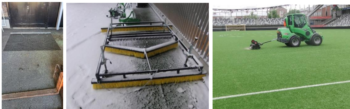
Kuva 46. Tekonurmikenttien hoitokalustoa: tasoitusmatto, tekonurmiharjakset ja kuohkeutuslaite.
