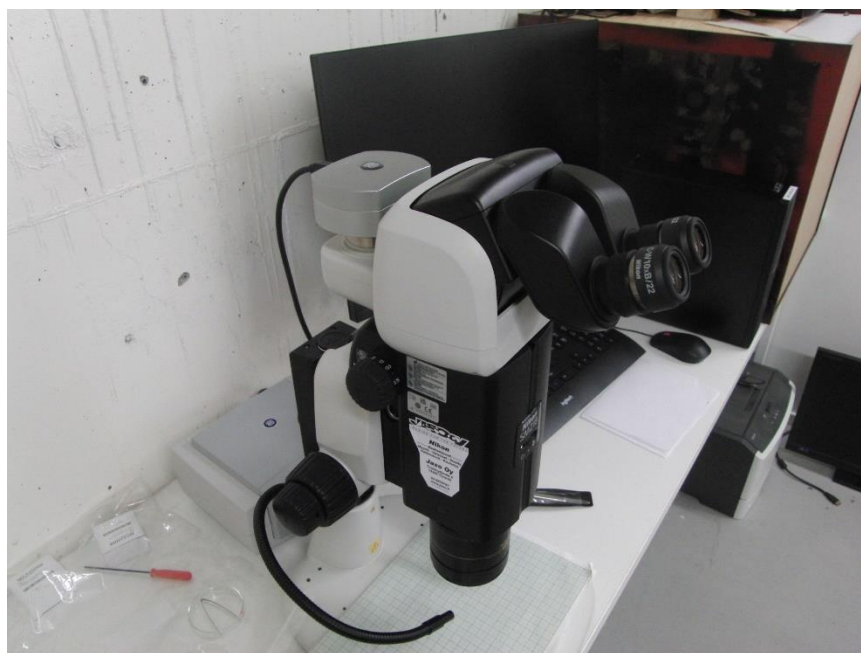
Kuva 4. Nikon SMZ18 -stereomikroskooppi.
