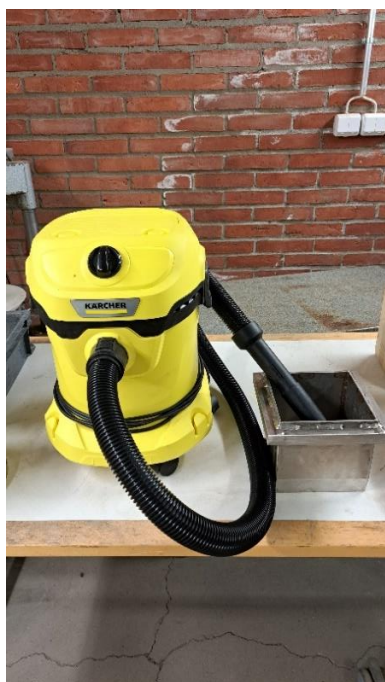
Kuva 3. Pölynimuri ja näytekaulus (150 mm x 150 mm).
