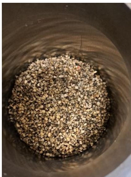
Kuva 44. Maissintähkärakeet kulutuskokeen jälkeen.
