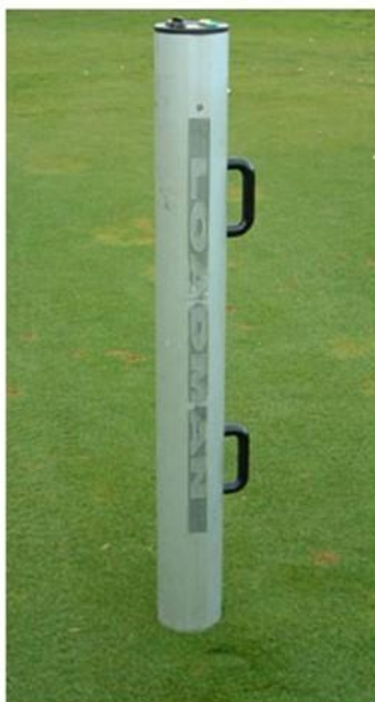
Kuva 2. Kannettava pudotuspainolaite Loadman II ja laitteen periaatekuva.
