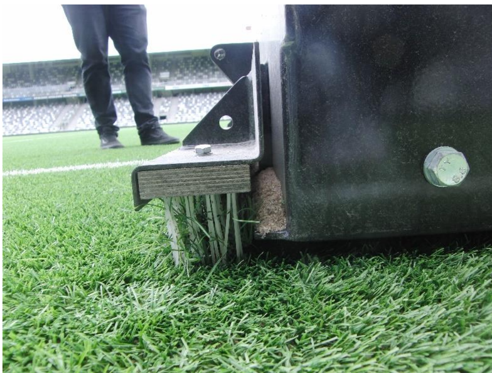
Kuva 47. Tekonurmikenttien kuohkeutuslaitteen muoviharjakset.
