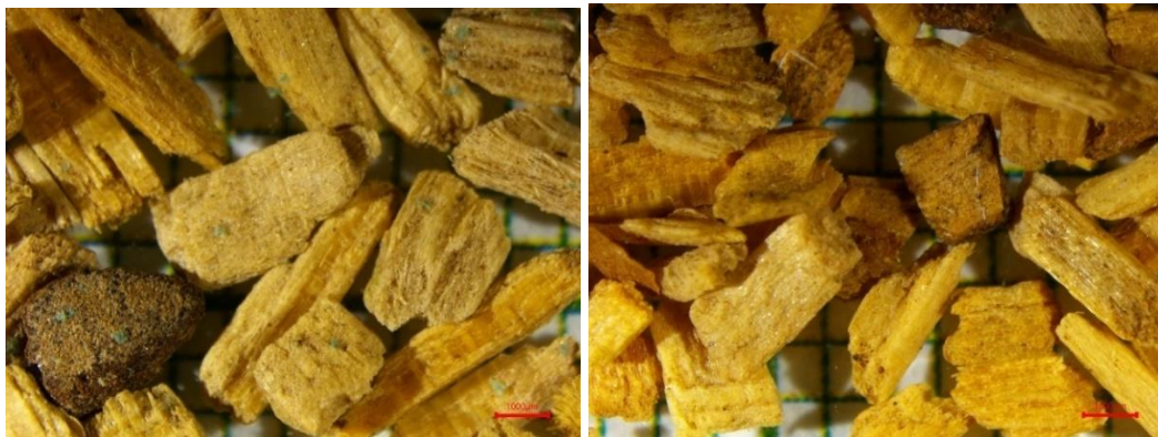
Kuva 11. Puurouhetta, vasemmalla näyte Pajamäen kentältä, oikealla näyte Kaapon kentältä. Kuvassa punainen mittajana on 1 mm.
