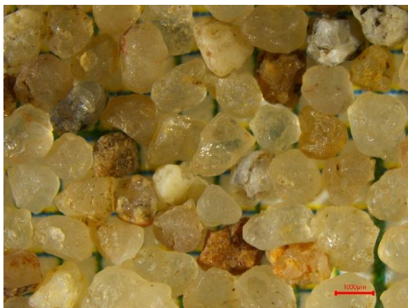
Kuva 8. Raekokoon 1–2 mm seulottua kotimaista Viasveden Hiekka- ja Kuljetusliike Oy:n kvartsihiekkää. Kuvassa punainen mittajana on 1 mm.
